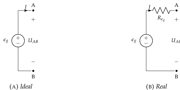
FIGURA 1.15: Generador de tensión
