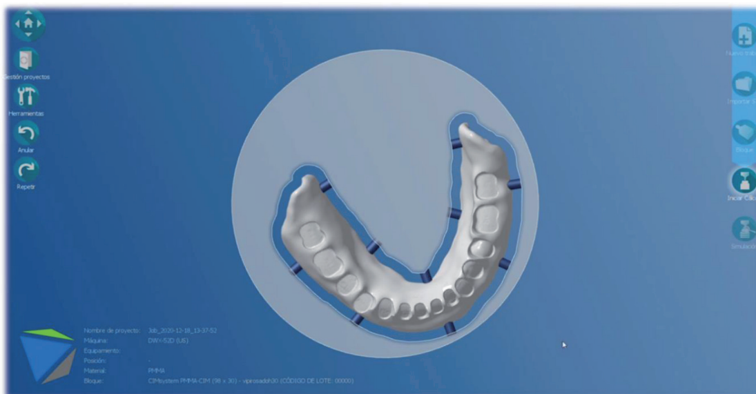
Figura 10-26 Captura de pantalla del programa Millbox LAV. Se aprecia el anidado del archivo STL de la prótesis inferior con sus conectores, ubicado dentro de los límites del disco que será fresado.
